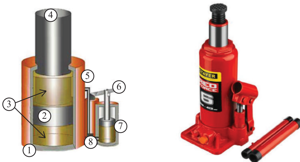
5-rasm. Yuk ko‘tarish moslamasi (domkrat): 1 – asos; 2 – porshen; 3 – ishchi suyuqlik (jidskost); 4 – tayanch nuqtasi; 5 – silindr; 6 – dasta; 7 – nasos; 8 – bosimni pasaytiruvchi klapan.
